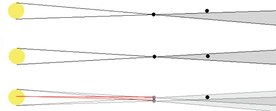
Abbildung 1: Beim Venustransit ergibt sich zu einer bekannten Bogenlänge, dem Durchmesser der Erde, ein aus der Durchgangszeit berechenbarer Winkel (rot hervorgehoben).
