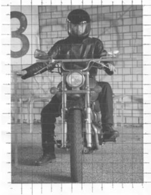
**Abb. 2:** Messung der Frontfläche zur Berechnung des cw-Wertes bei der Kawasaki EN 5
