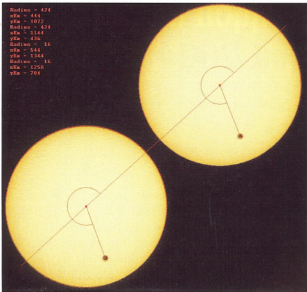
3 Ausmessung der Venuspositionen am Computer durch Anpassung von Kreisen
